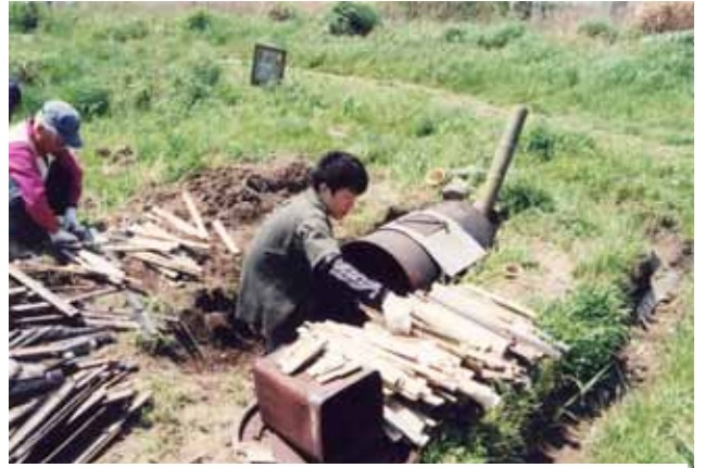
ドラム缶に割った竹を整然と並べて詰め込む
